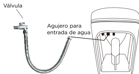
Instrucción para referencias sin tanque de agua.
